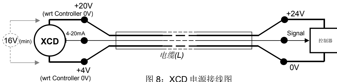
图 8: XCD 电源接线图
